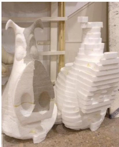
Figura 24: Proceso de postlijado de la CNC (González, 2018)
