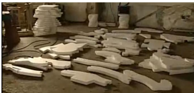
Figura 21: Piezas de poliespán cortadas por CNC (Orozco-Messana, 2008).
