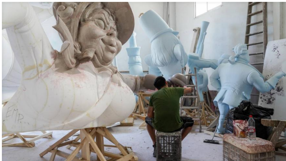
Figura 4: Proceso de fabricación de monumentos falleros con poliéster expandido
