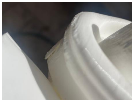
Figura 122: Desgarre de material derivado del proceso de lijado
