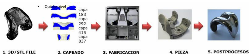
Figura 28: Proceso de fabricación aditiva (AIDIMME, 2026)
