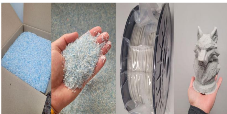
Figura 55: Escamas de material reciclado PET procedente de planta de reciclaje de SP-BERNER y figura impresa con dicho material. (UPV, s.f.)
