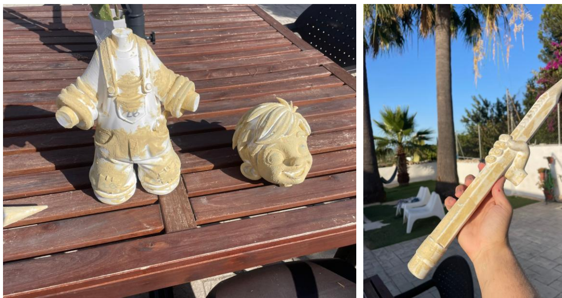
Figura 124: Apéndices del modelo masillados y apéndiz del lapiz masillado y lijado
