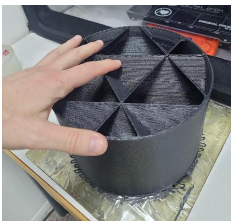
Figura 54: Impresión con un 90% de material reciclado (UPV, s.f.)
