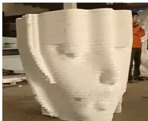
Figura 23: Vista del ninot con la superficie lista para el modelado manual final (Orozco-Messana, 2008).
